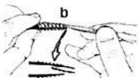
Использование тонкого конического камня при заточке и очистке внутреннего отверстия бура
